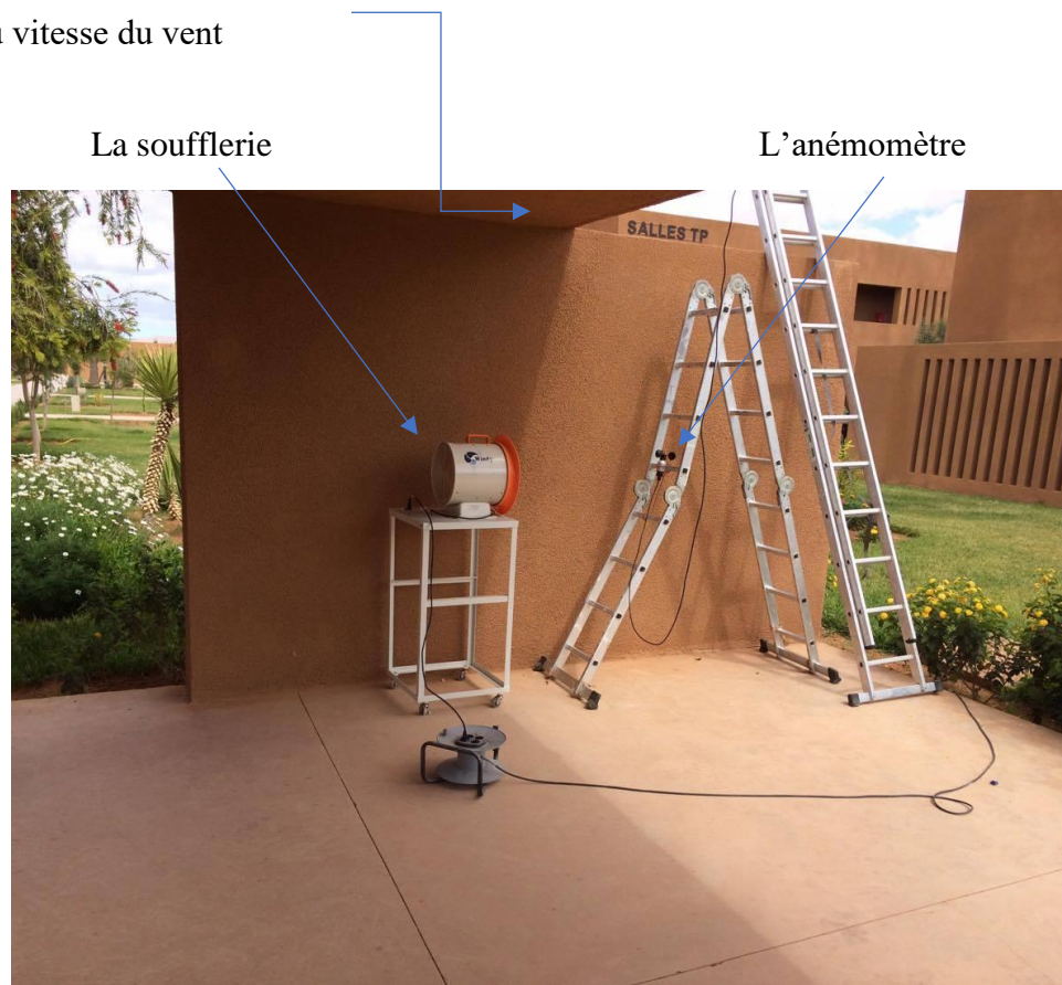
Figure 38 : le montage de mesure de la vitesse du vent
