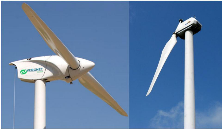
Figure 12 : les éoliennes bipales et monopales
